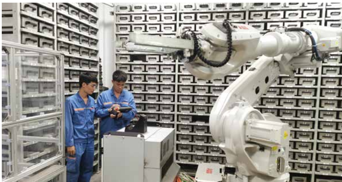
国检集团持续提升技术服务能力，打造“四全”生态型业务架构。图为国检美诺福公司为钢铁企业提供生产试样检测服务的全自动存样系统
