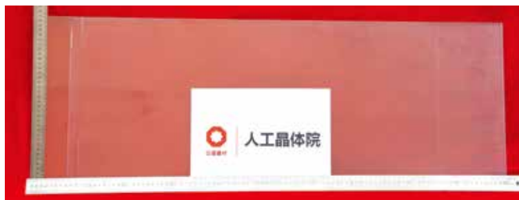
具有国内领先水平的大尺寸蓝宝石晶体
